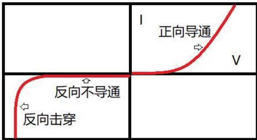
图 5.二极管电流电压曲线
